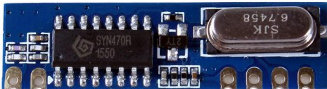
Modulo ricevitore a 433 MHz con modulazione ASK/OOK, basso consumo, alta immunità ai disturbi e bassa radiazione in antenna. Alimentazione: da 3,3 Vdc a 5 Vdc, impedenza d'antenna: 50 ohm, dimensioni (mm): 33,1 x 9,1 x 4,8
