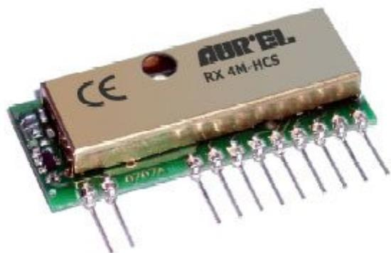
Ricevitore ad elevata selettività con decodifica HCS integrata. La modalità monostabile, bistabile e la presenza di uscite di tipo open collector, lo rendono ideale come elemento di controllo in apparati tipo apricancello, antifurto e genericamente in applicazione ove è richiesta la codifica del canale. Applicazioni: comandi luci, automazione domestica, controlli remoti, controllo accessi. (Codice Aurel: RX-4MHCS, 650200997).
