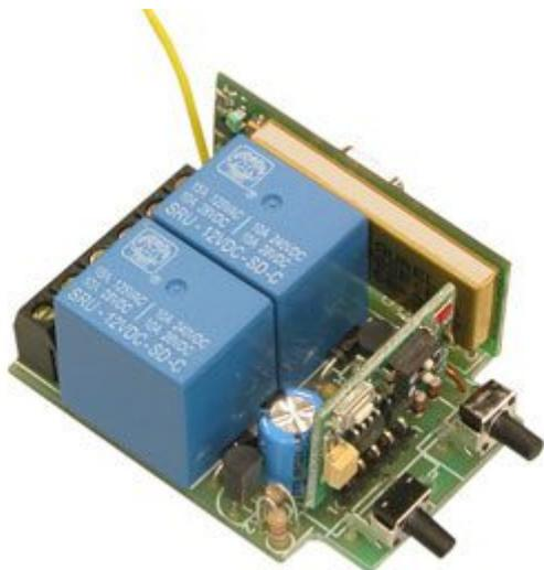
Ricevitore AM supereterodina a due canali dotato di decoder ad autoapprendimento del codice in grado di funzionare sia con sistemi a 12 bit che con la codifica KeeLoq (Rolling Code) di casa Microchip. Il sistema può essere utilizzato in molteplici applicazioni: per attivare elettroserrature, cancelli elettrici, porte basculanti, sistemi di irrigazione, avvisatori acustici, impianti antifurto, eccetera. Al ricevitore può essere abbinato il TX palmare HCS-TX2-868.
