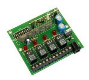
Sistema di controllo remoto a quattro canali con uscita a relè operante nella frequenza standard di 433,92 MHz . Dispone di 1024 combinazioni e garantisce una portata di circa 50 metri in assenza di ostacoli. I relè di uscita possono operare sia in modalità bistabile che in modalità astabile e sono adatti per carichi fino a 1 A.
