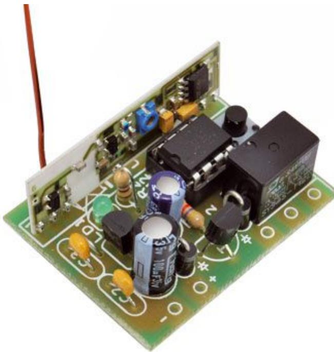
Piccolo ricevitore monocanale a basso costo per codifica MM53200 e HT-12, con funzione di autoapprendimento dei codici. La decodifica e l'abbinamento dei codici dei dieci trasmettitori sono affidati a un microcontrollore della Microchip, il cui firmware è in grado di adattarsi alla frequenza di clock del codificatore posto sul trasmettitore, (purché sia 1,7 kHz, di sincronizzarsi con esso e quindi di estrarre il codice per memorizzarlo, ovvero analizzarlo al fine di comandare l'uscita a relé.
