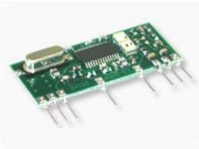
Ricevitore supereterodina economico ad elevata sensibilità che, grazie a una nuova tecnica circuitale, non necessita di filtro SAW per garantire un'alta immunità ai disturbi. Specifiche Tecniche: Frequenza: 433.92 MHz, Sensibilità: -115 dBm (\*), Bit rate: 2400 bps, Dimensioni: 38.9 x 17.5 x 5.2 mm, Alimentazione: 3 V, Consumo: 5.8 mA.
