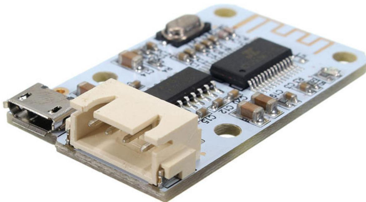
Compatto ricevitore bluetooth con amplificatore audio in classe D 2x3 watt che permette di riprodurre i file audio provenienti da smartphone, tablet o altro dispositivo. È particolarmente adatto per pilotare due altoparlanti con 4-8 ohm di impedenza. Si alimenta tramite il connettore micro USB, mentre le uscite per gli altoparlanti sono disponibili sul connettore a 4 pin passo 2,54 mm.
