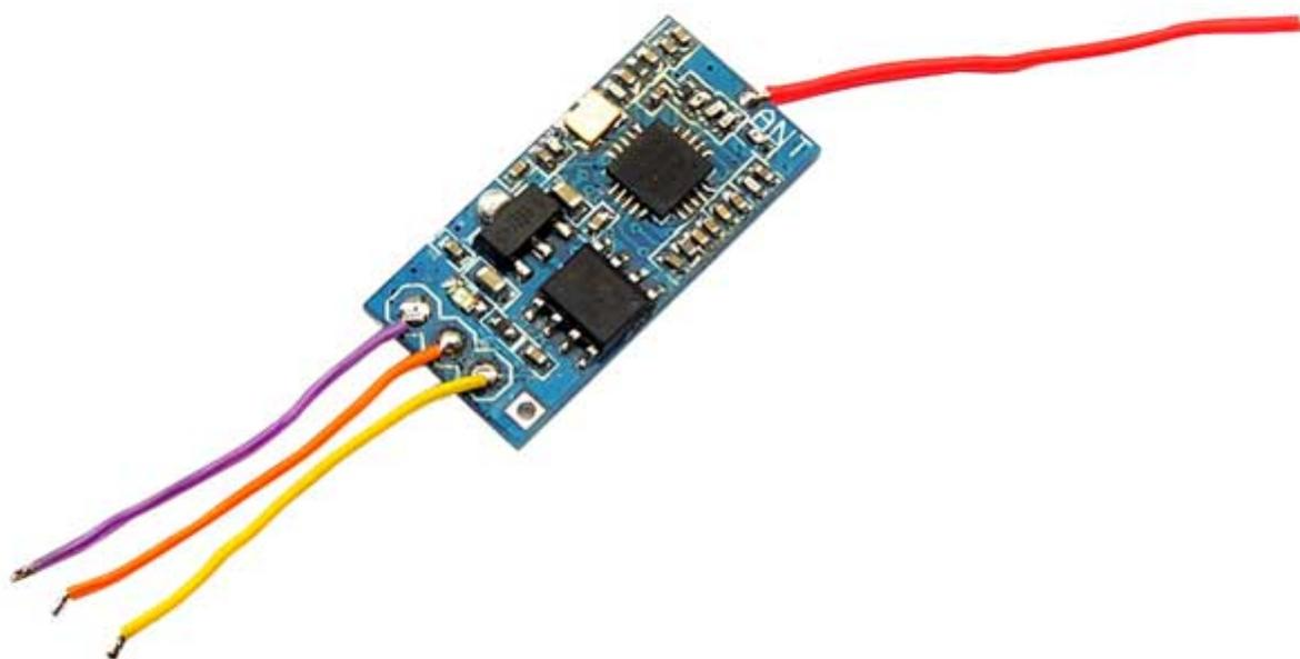
Ricevitore Flysky a 6 canali con uscita PPM funzionante a 2,4 GHz. Compatibile con i seguenti dispositivi e trasmettitori: FS-I6, TH9X GT2B, GT3, GT3B, GT3C ecc, Eachine I6, ER9X, OPENTX con sintonizzatore Flysky ecc, Walkera D7E, D10 con modulo A7105 Module ecc. Alimentazione 5 Vdc, dimensioni (mm): 23x11, peso: 6 grammi.
