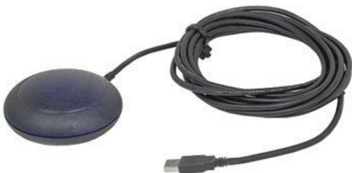
Il NAVI-S-U6-USB, dotato del chipset [UBX-G6010](#) della U-blox, è uno tra i più sensibili e precisi ricevitori GPS a 50 canali paralleli presenti sul mercato. Dispone di batteria di backup integrata per SRAM e RTC. Il collegamento USB permette di utilizzarlo con tutti i computer di ultima generazione (viene creata una porta seriale virtuale attraverso la quale invia al PC i dati rilevati).
