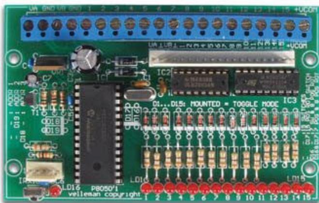
Ricevitore IR a 15 uscite gestito da microcontrollore in grado di funzionare con numerosi kit Velleman: K6710, K8049, K8051, K8055, K8056, K6714, K6714-16, K2633, .. Uscite open-collector max. 50V/50mA, led di uscita per ciascun canale, possibilità di utilizzare più sensori IR, portata superiore a 20 metri.
