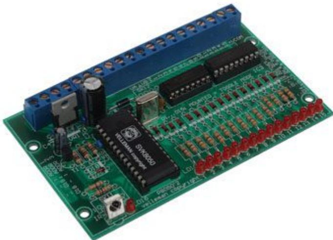
Ricevitore IR a 15 uscite gestito da microcontrollore particolarmente indicato per funzionare con il trasmettitore a 15 canali montato VM121. Uscite open-collector max. 50V/50mA, led di uscita per ciascun canale, possibilità di utilizzare più sensori IR, portata superiore a 20 metri. E' la versione montata del kit K8050.
