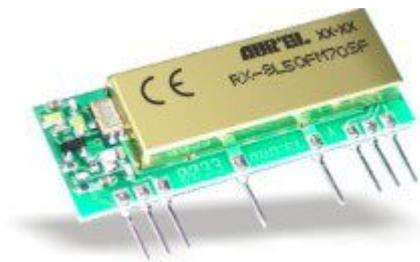
Ricevitore supereterodina di dati digitali modulati in FSK, operante alla frequenza di 868,3 MHz. Elevata selettività e sensibilità garantiscono ottime prestazioni di immunità ai disturbi. Il modulo è pin-to-pin compatibile con la serie di ricevitori OOK AUREL. Specifiche Tecniche: Alimentazione 5 V, Consumo 7 mA, Frequenza 868.3 MHz, Sensibilità - 107 dBm, Bit rate 9600 bps, Dimensioni 44.9 x 17.5 x 9.3 mm.
