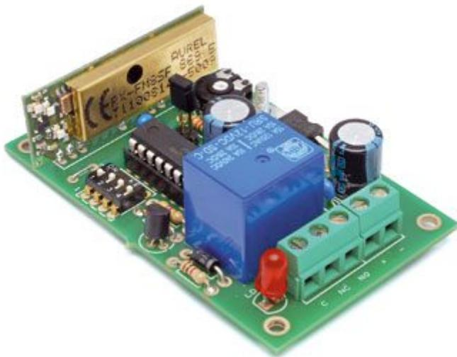
Ricevitore monocanale operante a 869 MHz da utilizzare con il trasmettitore per telecomando FT842K. Utilizza un microcontrollore, il quale ha il compito di decodificare i segnali in arrivo dal ricevitore ibrido (RX-FM8SF869) e gestire il relè di uscita (monostabile e bistabile). Alimentazione 12 Vdc.
