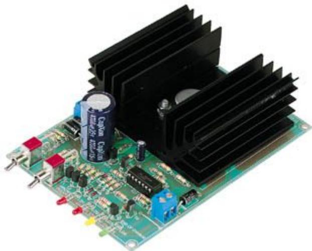
Questo caricatore / condizionatore consente di caricare e mantenere efficienti batterie al piombo da 6 o 12V. Corrente di carica variabile da 0.3 a 1A. La batteria può rimanere connessa al circuito per un tempo indefinito mantenendo uno stato ottimale. Il tipo di batteria e la corrente di carica sono selezionabili, mentre il processo di carica è completamente automatico.
