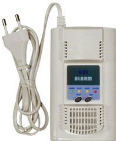
Rilevatore in grado di segnalare la presenza di fughe di gas metano. Soglia di allarme tarata sul livello di 10% LEL (Lower Explosive Limit). Dispone di allarme sonoro con 85dB di potenza (ad una distanza di 1 metro), 4 LED di segnalazione e pulsante di test. Alimentazione: 220 Vac, consumo: 3 watt. Facile da installare e sicuro per tutti gli occupanti della vostra abitazione.
