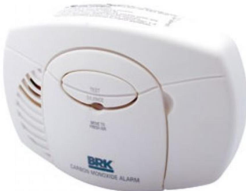
Rilevatore di monossido di carbonio dotato di sensore elettrochimico. Funzionante con due batterie da 1,5 V (AA) e in grado di segnalare con un potente avvisatore acustico la presenza del monossido di carbonio (CO). Conforme allo standard UL2034 è progettato per entrare in allarme ai seguenti livelli di esposizione (CO): >400ppm, >150ppm e >70ppm. Montaggio a parete o su scrivania. Dimensioni: 85 mm x 120 mm x 25 mm.
