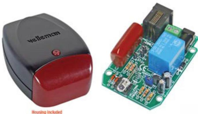
Ideale per essere utilizzato come suoneria supplementare o per sostituire quella esistente. Il suo impiego è particolarmente indicato in ambienti rumorosi o per chi ha problemi di udito. Dispone di un led ad alta luminosità e di un relè che si attivano quando è in arrivo una chiamata. Compatibile con linea di tipo PSTN. Necessita di un adattatore di rete a 12 Vdc per abilitare l'uscita a relè. Funzionamento del relè selezionabile (ad intermittenza o continuo).
