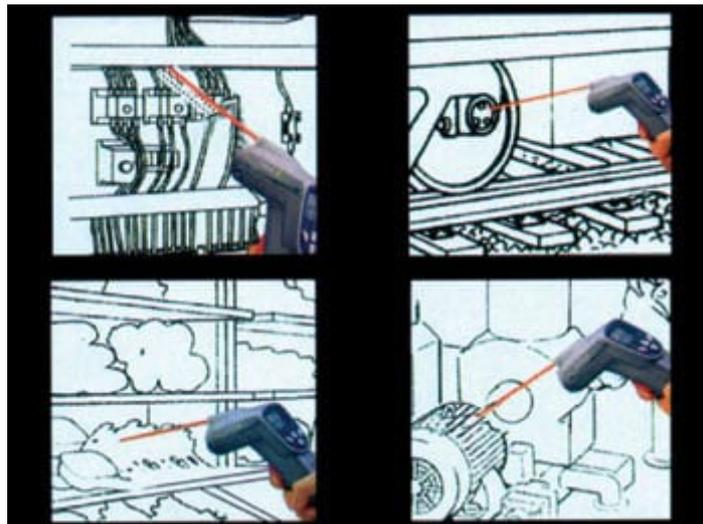
Sistema ad infrarossi per la misura della temperatura a distanza. Possibilità di visualizzazione in gradi centigradi o in gradi Fahrenheit, display LCD con retroilluminazione, memorizzazione, spegnimento automatico.
