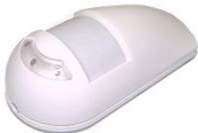
Rivelatore d'intrusione ad effetto piroelettrico passivo con segnalazione remota mediante trasmissione codificata RF HCS/HT12E (selezionabile). Segnalazione acustica batteria scarica e protezione anti-apertura. Dispone di snodo che permette di ottenere la giusta inclinazione al fine di coprire in maniera ottimale la zona desiderata.
