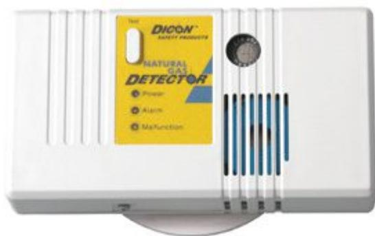
Rilevatore di fughe di gas metano. Apparecchiatura dalle caratteristiche professionali alimentato con tensione di rete in grado di segnalare la presenza di fughe di gas metano. Soglia di allarme tarata sul livello di 25% LEL. Alimentazione a 230 Vac mediante adattatore d rete, consumo di 7 watt, 3 led di segnalazione, pulsante di test, buzzer di allarme da 85 dB.
