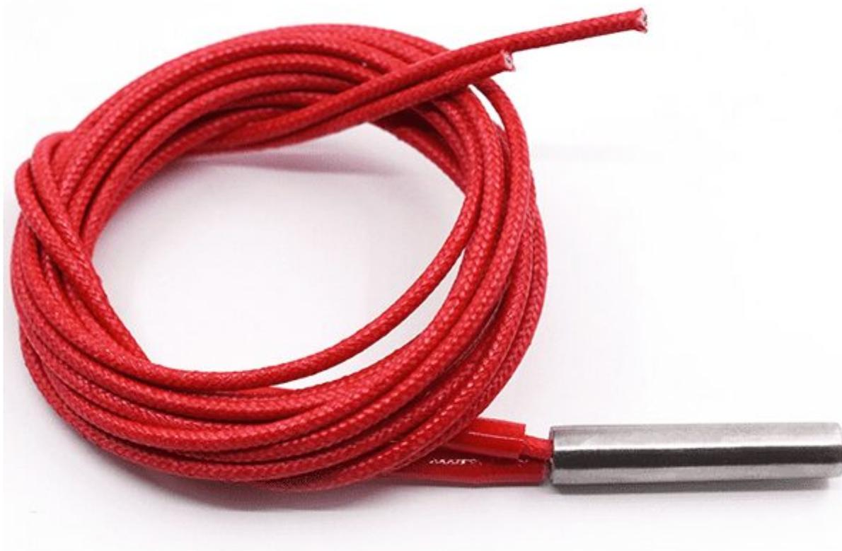
Riscaldatore in acciaio inossidabile per corpo estrusore per stampante 3D (DMAKE e 3D4040 – vedere prodotti correlati). Alimentazione: 12 volt, potenza: 40 watt, resistenza 6,8 ohm, diametro corpo: 6 mm, lunghezza corpo: circa 20 mm, lunghezza cavi: 1 metro.
