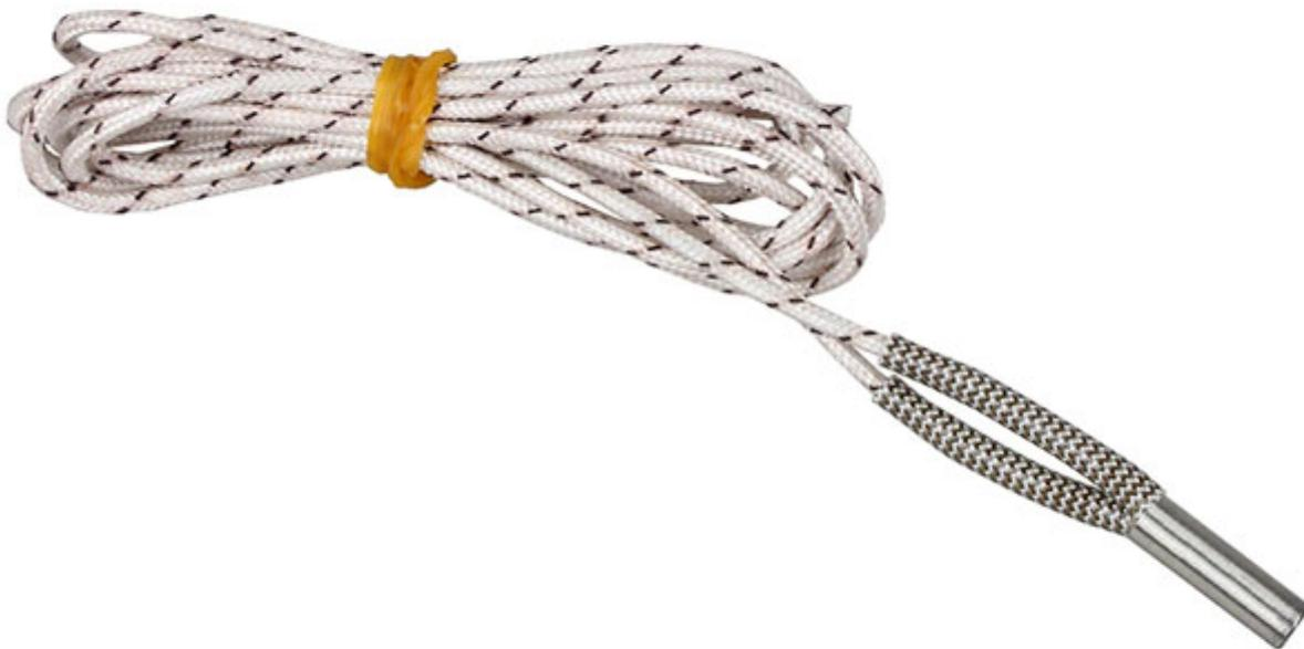
Riscaldatore in acciaio inossidabile, solitamente utilizzato per il corpo estrusore delle stampanti 3D, può essere utilizzato anche in altre applicazioni. Alimentazione: 24 volt, potenza: 50 watt (raggiunge circa 350°C), resistenza 11,2 ohm, diametro corpo: 6 mm, lunghezza corpo: circa 20 mm, lunghezza cavi: 1 metro.
