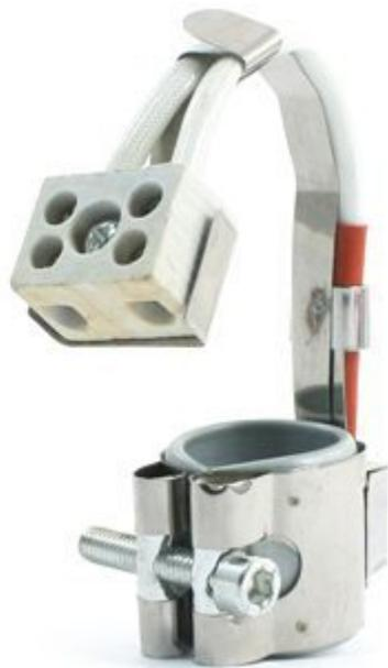
Riscaldatore a collare in grado di raggiungere una temperature di 300-400°C. Realizzato in acciaio inox, ha un diametro interno di 25 mm e un'altezza di 30 mm. Viene alimentato a 220 Vac e ha una potenza di 70 watt. Impiegato nel progetto della Fila extruder pubblicato sul numero 206 della rivista Elettronica In Giugno 2016. Peso: 76 grammi.
