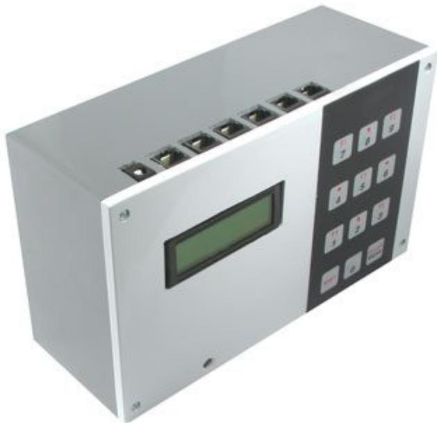
Risponde in modo automatico quando è in arrivo una chiamata rispettando gli orari giornalieri prestabiliti. E' in grado di gestire fino a sei linee telefoniche e per ognuna è possibile registrare un messaggio vocale di 20 secondi. Dotato di display LCD retroilluminato e di una tastiera a 12 pulsanti per le impostazioni. Il kit è composto da una scheda base (FT540K) e da un massimo di sei moduli vocali (FT538K). Non è compreso il contenitore plastico disponibile separatamente.
