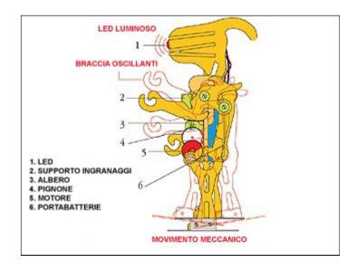
Modello motorizzato in legno facilmente realizzabile da chiunque. Consente di prendere confidenza con i sistemi di trasmissione del moto, dagli ingranaggi alle pulegge. Non richiede l'impiego di un saldatore né di alcun tipo di colla. Dimensioni: 90 x 210 x 80 mm.
