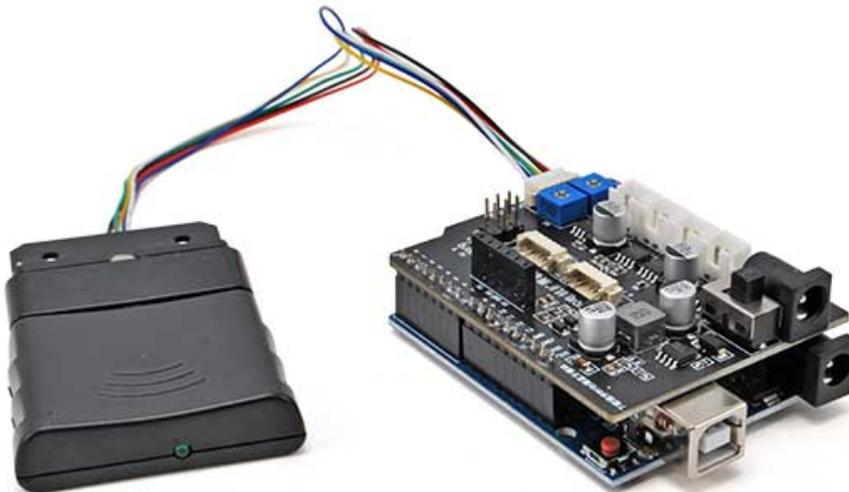
Lo shield montato sulla scheda Arduino compatibile collegato al ricevitore wireless.[/caption]
