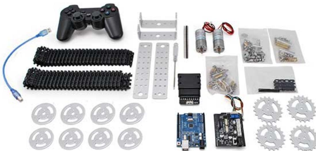
Il kit comprende tutte le parti meccaniche necessarie per realizzare un robot cingolato, e l'elettronica: lo Shield, la scheda Arduino compatibile, il ricevitore wireless, due motoriduttori. Istruzioni per il montaggio in italiano.[/caption]
