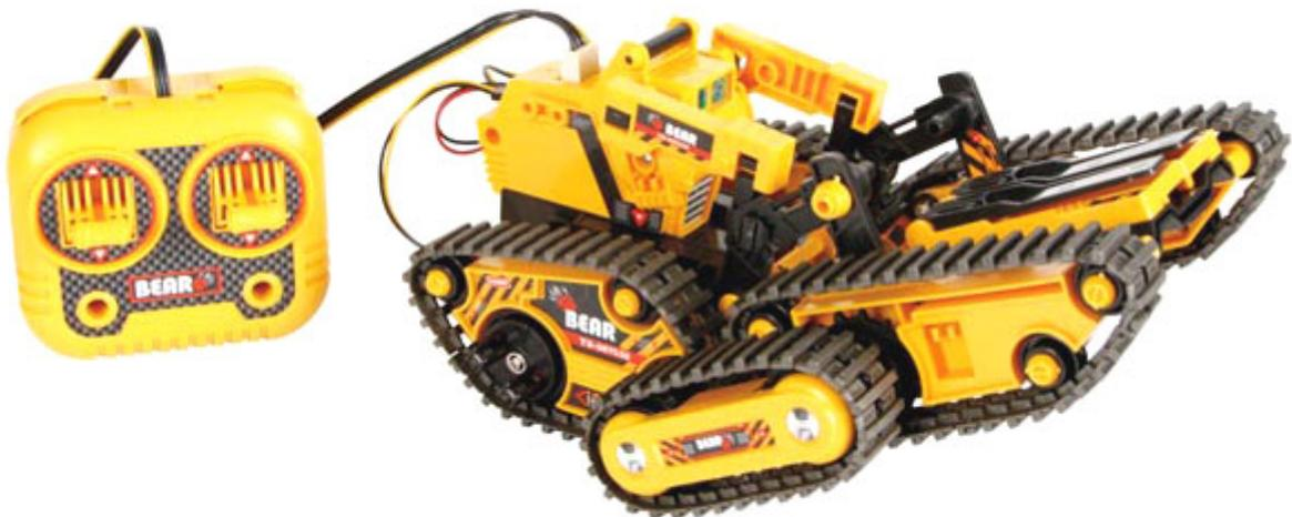
Entra anche tu nell'affascinante mondo della robotica, e scopri le tecnologie di base, realizzando un robot cingolato con 3 configurazioni possibili (carrello elevatore, rover e pinza meccanica). I movimenti del robot (avanti/indietro, rotazione destra/sinistra, sollevamento/abbassamento), sono gestiti tramite un'unità di controllo via cavo. Alimentazione: 4 batterie AA (non incluse), peso: 425g. N.B. il robot non è programmabile.
