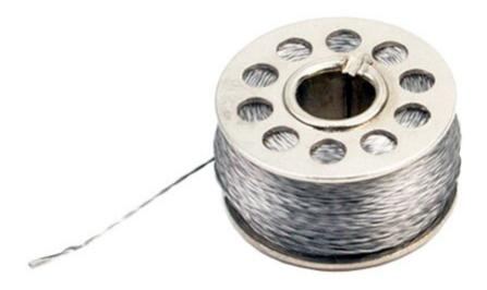
Rocchetto contenente 15 metri di filo conduttivo in fibra di acciaio inossidabile. È dotato di una resistenza di 9 Ohm, diametro: 0,33 mm, buona conduttività termica e resistenza alle alte temperature. Può essere utilizzato per realizzare guanti touchscreen, indumenti antistatici, apparecchiature elettroniche indossabili, ecc.
