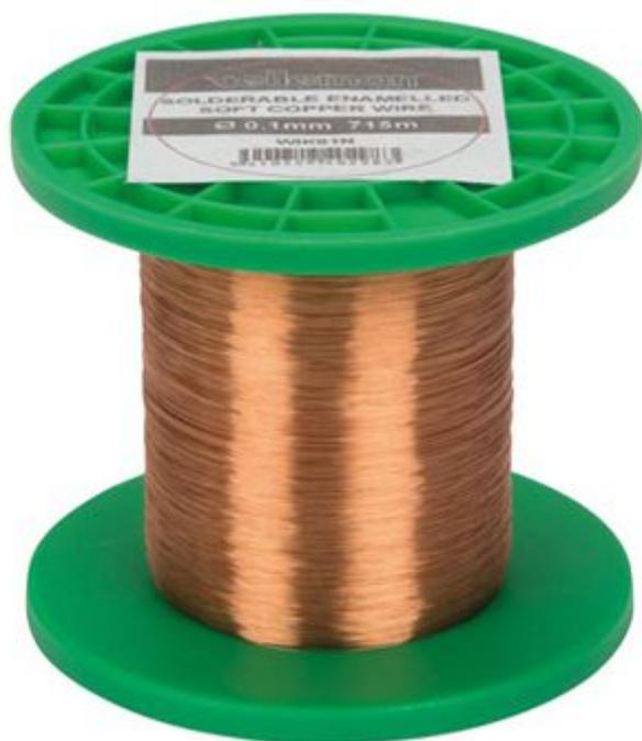
Filo di rame smaltato per avvolgimenti su rocchetto. Diametro: 0,1 mm, lunghezza: 715 metri, resistenza: 1,55 kohm, dimensioni rocchetto: 65 x 35 mm; peso: 50 g.
