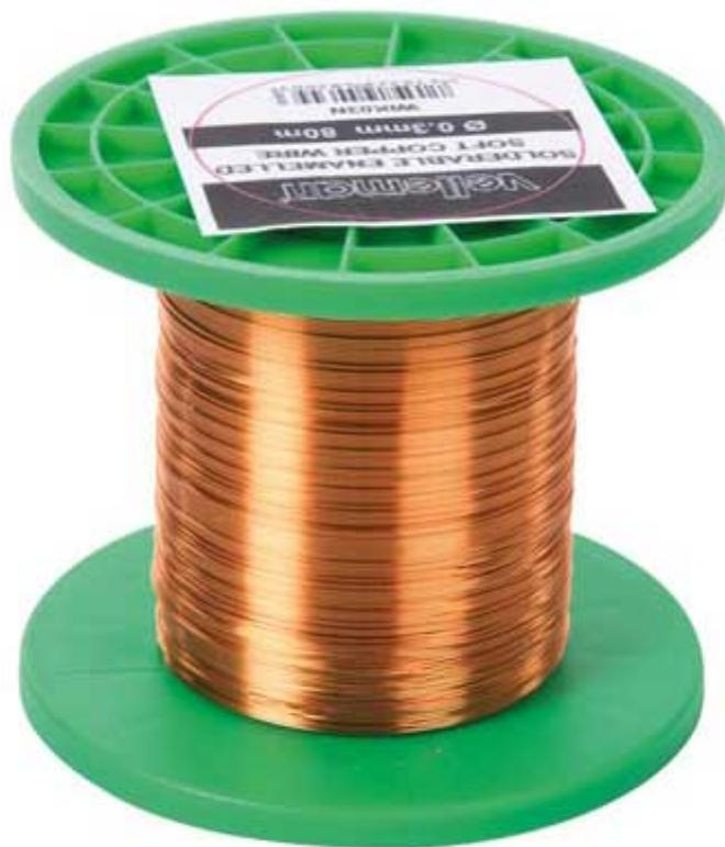
Filo di rame smaltato per avvolgimenti su bobina. Diametro: 0,3 mm, lunghezza: 80 m, dimensioni rocchetto: 65x35 mm; peso: 50 g.
