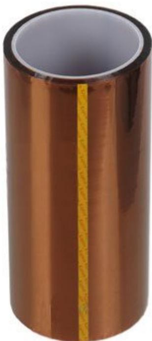
Rotolo di nastro adesivo Kapton, alto 200 mm, lungo 30 metri e spesso 0,05 mm. Largamente impiegato come isolante termico (dai -269 °C a +400 °C), isolante nei cablaggi elettrici e nei circuiti stampati flessibili. Il suo utilizzo è particolarmente indicato per rivestire l'estrusore e il piatto riscaldato delle stampanti 3D.
