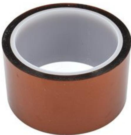
Rotolo di nastro adesivo Kapton, alto 55 mm, lungo 33 metri e spesso 0,05 mm. Largamente impiegato come isolante termico (dai -269 °C a +400 °C), isolante nei cablaggi elettrici e nei circuiti stampati flessibili. Il suo utilizzo è particolarmente indicato per rivestire l'estrusore e il piatto riscaldato delle stampanti 3D.
