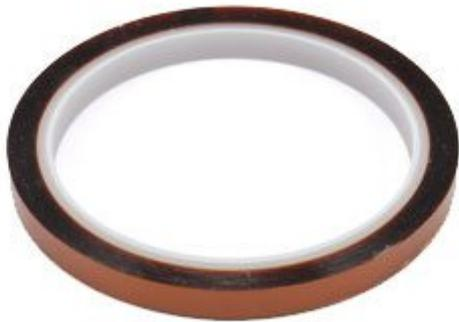
Rotolo di nastro adesivo Kapton, alto 8 mm, lungo 33 metri e spesso 0,05 mm. Largamente impiegato come isolante termico (dai -269 °C a +400 °C), isolante nei cablaggi elettrici e nei circuiti stampati flessibili. Il suo utilizzo è particolarmente indicato per rivestire l'estrusore e il piatto riscaldato delle stampanti 3D.
