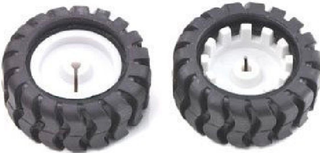
Ruota in plastica bianca con pneumatico. Diametro esterno ruota: 42 mm, larghezza del pneumatico 19 mm. Progettate per adattarsi all'albero dei micro motoriduttori in metallo della serie MMGxxx. Il cerchione della ruota è dotato di denti; collegando un encoder ottico (7300-ENCODER4219) è possibile sapere la posizione e la direzione. **Attenzione !** La confezione comprende solo 1 ruota.
