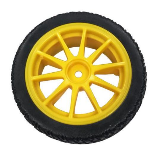
Ruota da 65 mm di diametro, pneumatico in gomma morbida con larghezza 26 mm e attacco per trascinatore con esagono 12 mm (vedere prodotti correlati). Indicata per essere utilizzata per realizzare piccoli robot su ruote, modellismo, ecc.
