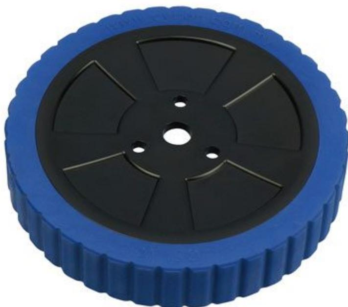
Ruota in ABS con diametro esterno di circa 127 mm e pneumatico in [TPE](#) con larghezza 25,4 mm. Particolarmente indicata per essere utilizzata con i motori di potenza con HUB (vedere prodotti correlati), dispone di una buona forza di attrito sulla maggior parte della superfici.
