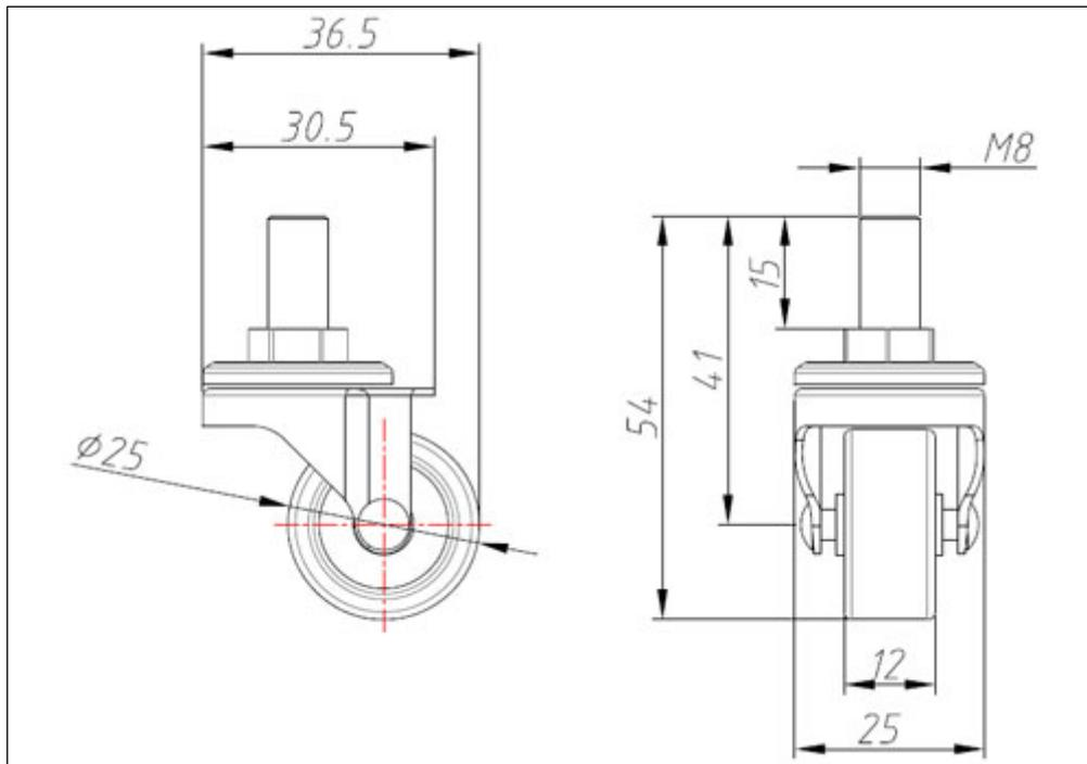
Confezione contenente 2 ruote pivotanti in plastica con struttura in acciaio e complete di dado per il fissaggio. Possono essere impiegate come terzo punto d'appoggio nei robot.
