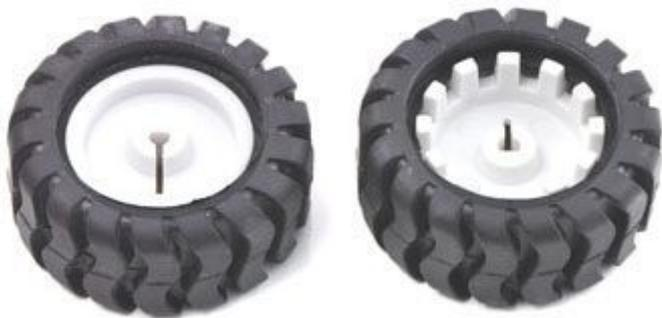
Confezione contenente una coppia di ruote in plastica bianca con pneumatico. Diametro esterno ruota: 42 mm, larghezza del pneumatico 19 mm. Progettate per adattarsi all'albero dei micro motoriduttori in metallo della Pololu (7300-MMG298). Il cerchione della ruota è dotato di denti; collegando un encoder ottico (7300-ENCODER4219) è possibile sapere la posizione e la direzione.
