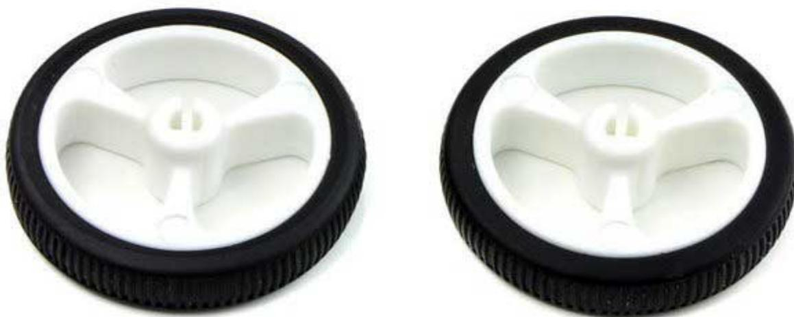
Confezione contenente una coppia di ruote in plastica bianche con pneumatico. Diametro esterno ruota (con pneumatico): 40 mm, larghezza del pneumatico 7 mm. Progettate per essere inserite con facilità sull'alberino a "D" da 3 mm dei micro motoriduttori in metallo della serie MMGxxx. Peso: 3,2 grammi.
