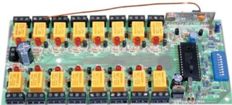
Ricevitore a distanza in UHF a 433,92 MHz codificato a base MM53200 / UM86409, utilizzabile con i trasmettitori standard di pari frequenza e con uguale encoder. Ogni unit
