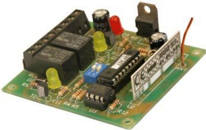
Ricevitore ad autoapprendimento basato sul sistema di codifica Keeloq Microchip, realizzato grazie ad un microcontrollore appositamente programmato. Dispone di due uscite a rel
