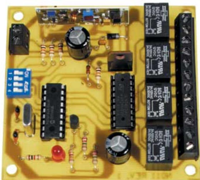
Ricevitore a 433 MHz con 4 canali indipendenti funzionanti in modo impulsivo o bistabile. Gestito da microcontrollore, autoapprende i codici del trasmettitore e li memorizza in una EEPROM. La sezione ricevente utilizza un modulo ibrido Aurel a 433 MHz. Il dispositivo autoapprende i treni di impulsi generati dai codificatori della serie MM53200, UM3750, UM86409, ecc. Il kit comprende tutti i componenti, il micro programmato e il modulo ricevitore Aurel; non
