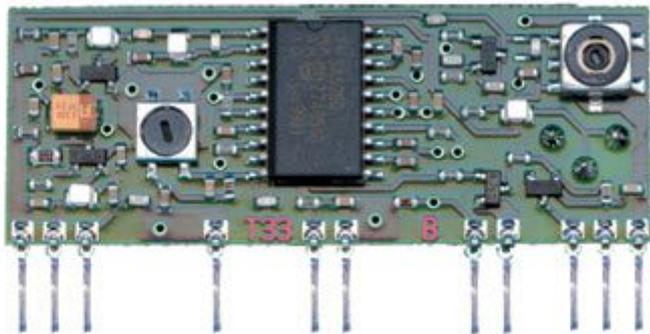
Ricevitore FM supereterodina a 433,8 MHz, studiato appositamente per la ricezione audio, presenta ottime caratteristiche tecniche. Funzionamento a 3 volt, banda di uscita BF da 20 Hz a 20 KHz con un segnale tipico di 90mV RMS, sensibilità RF -100 dBm, impedenza di ingresso 50 Ohm. Uscita per il controllo dello Squelch e possibilità di inserire un circuito di de-enfasi. Tensione di alimentazione 3 Volt. Il circuito risponde alle normative CE ETS 330 220. Dimensioni 50,8 x 20 x 4 mm.
