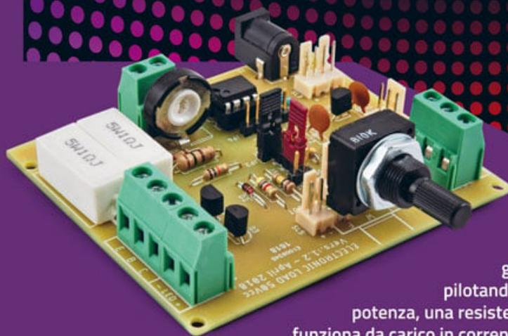
Costruiamo un circuito in grado di simulare, pilotando un transistor di potenza, una resistenza variabile che funziona da carico in corrente continua e che nel caso specifico è destinato al test dei regolatori di corrente per illuminazione a LED.
