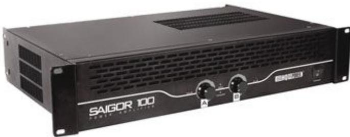
Amplificatore stereo di potenza 2x120 W rms su 4 ohm e 2x80 W rms su 8 ohm. Dispone di due potenziometri per il controllo del volume (1 per canale), LED di segnalazione alimentazione, protezione, distorsione e interruttore ON/OFF.
