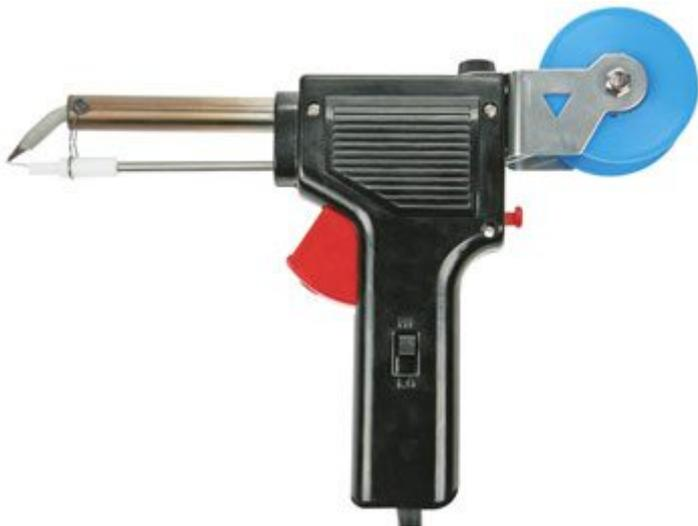
Saldatore a pistola con rocchetto portastagno. Grazie al suo sistema di avanzamento dello stagno, rende molto più semplice e veloce la saldatura, permettendo l'utilizzo di una sola mano. Doppia modalità di riscaldamento "HI" e "LO": posizione "HI" 60 W, posizione "LO" 30 W. Possibilità di selezionare la lunghezza, da 3 mm fino a 8 mm, dello stagno in uscita. Il rocchetto portastagno viene fornito con 2 metri di stagno senza piombo (Sn 99,3% - Cu 0,7%). Alimentazione 220 Vac.
