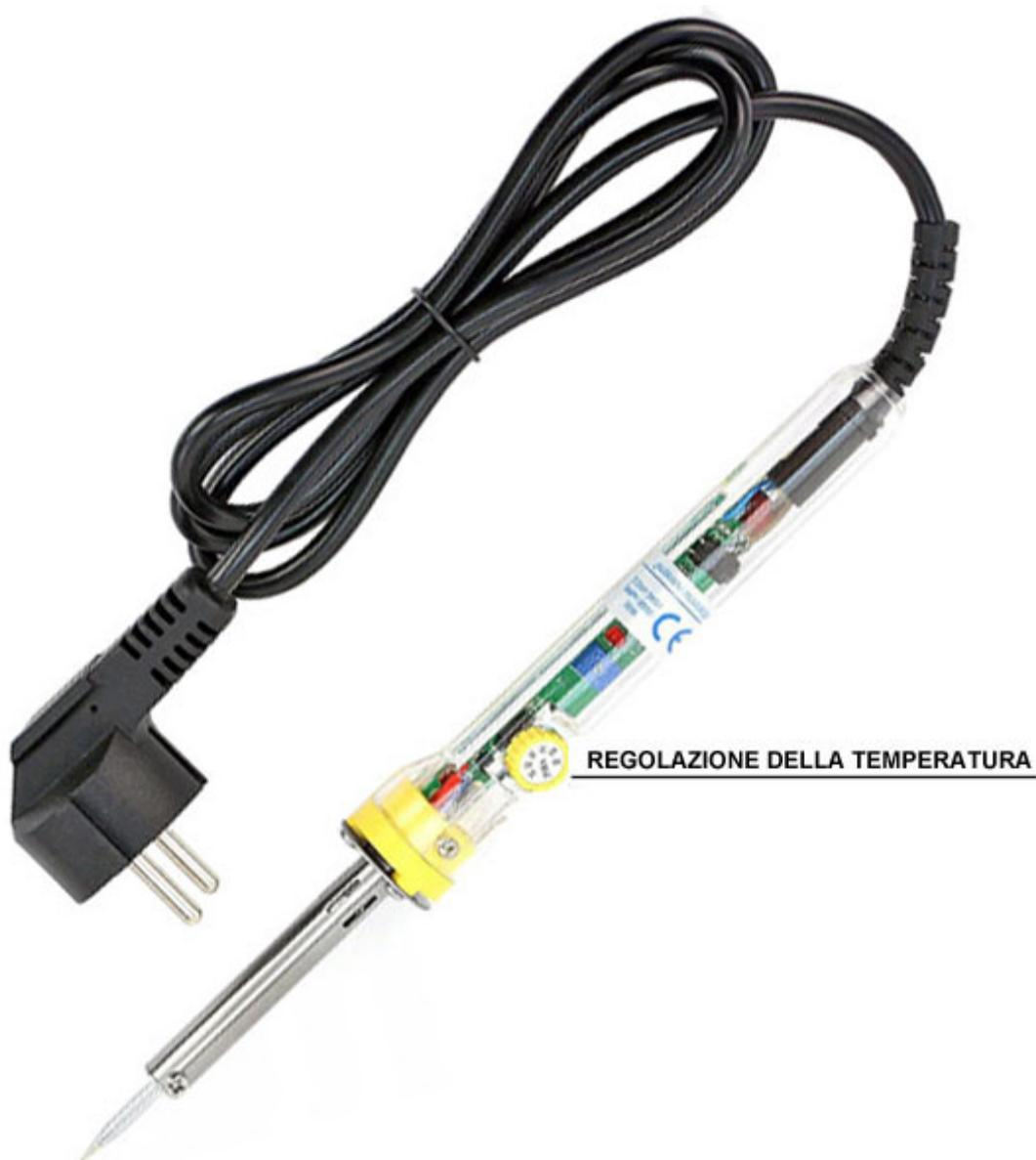
Saldatore da 30-50 watt con regolazione della temperatura della punta, da 200°C a 450°C, tramite regolazione elettronica della potenza. Dotato di una punta sottile diritta, sostituibile e di lunga durata, permette di effettuare saldature con stagno con e senza piombo.
