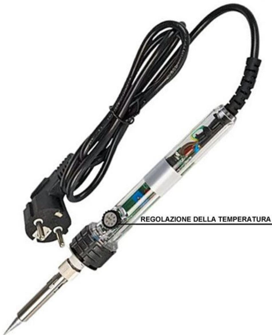
Saldatore da 30-50 watt con regolazione della temperatura della punta, da 200°C a 450°C, tramite regolazione elettronica della potenza. Dotato di una punta sottile diritta, sostituibile e di lunga durata, permette di effettuare saldature con stagno con e senza piombo.
