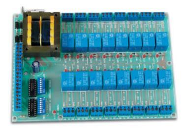
Scheda completa di 16 relè con relativo connettore per i contatti. Sezione di alimentazione completa di trasformatore. Uscita 12V DC utilizzabile per alimentare altri kit: K6714, K8023,... Ogni uscita può essere dotata di rete di soppressione rumore. I relè possono essere controllati in diversi modi: controllo diretto da uscite a collettore aperto, livelli TTL o CMOS. Sono previsti dei dip-switch per attivare direttamente i relè in caso di manutenzione.
