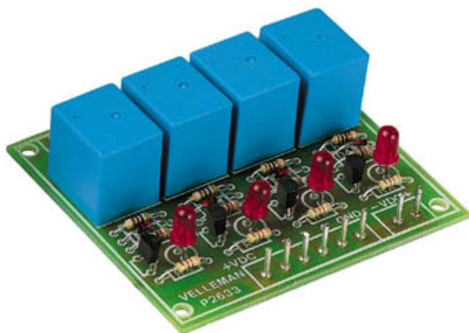
Consente di collegare quattro relè da 3 A alle uscite digitali di un circuito elettronico. Quattro LED segnalano l'attivazione della relativa uscita.
